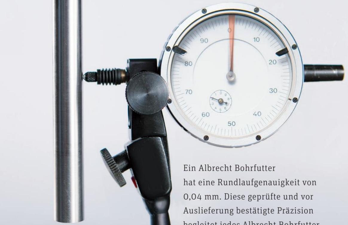
Ein Albrecht Bohrfutter hat eine Rundlaufgenauigkeit von 0,04 mm. Diese geprüfte und vor Auslieferung bestätigte Präzision begleitet jedes Albrecht Bohrfutter. Somit bieten wir als einer der ganz, ganz wenigen wirkliche Präzision. Und das Schöne daran, auf Grund seiner absoluten Präzision hält jedes Albrecht Bohrfutter sehr lange. Vermutlich ein Leben lang.
